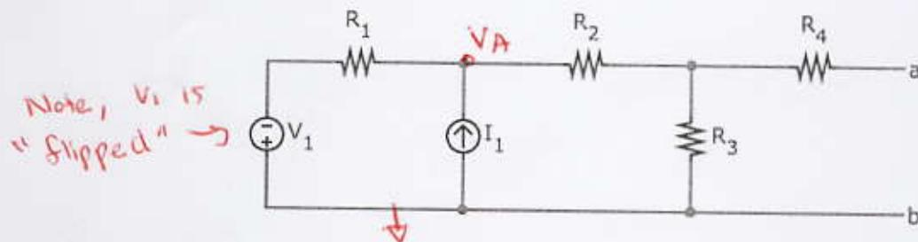
$$V_{\text{Thévenin}} = (I_1 R_1 - V_1) \cdot \frac{R_3}{R_1 + R_2 + R_3}$$
