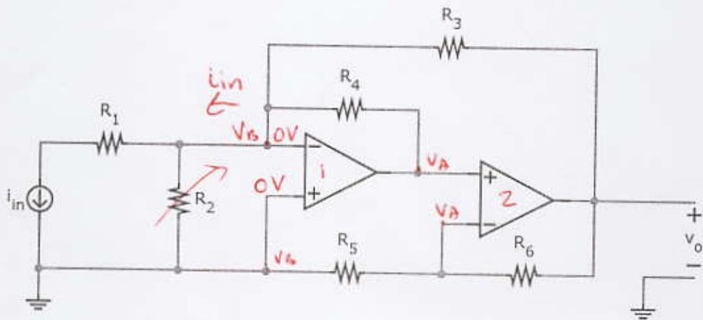
$$\frac{v_o}{i_{in}} = \frac{(R_5 + R_6) R_3 \cdot R_4}{R_4 \cdot R_5 + R_4 \cdot R_6 + R_5 \cdot R_3}$$
