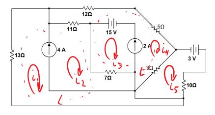
$$\begin{aligned} &|3i_{1} + ||(i_{2} - i_{4}) + 7(i_{2} - i_{3}) = 0 \\ &|3i_{1} + |8i_{2} - 7i_{3} - ||i_{4} \ge 0 1 2 \\ &i_{2} - i_{1} = 4A II \\ &7(i_{3} - i_{2}) + ||(i_{4} - i_{2}) + |2i_{4} + 5i_{4} + 3(i_{4} - i_{5}) = 0 \\ &- |8i_{2} + 7i_{3} + 3|i_{4} - 3i_{5} = 0 II \\ &i_{4} - i_{3} = 2A II \\ &2(i_{5} - i_{4}) - 3 + |0i_{5} = 0 \\ &- 3i_{4} + |3i_{5} = 3I \\ \end{aligned}$$
