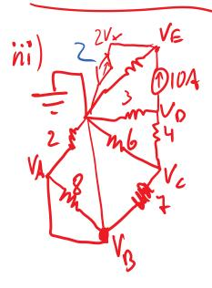
$V_{A} = V_{B} = OV$  $\frac{V_{c}}{1} + \frac{V_{c}}{6} + \frac{V_{c} - V_{0}}{4} = 0$ 47V2-21V0=0I1  $\frac{V_0 - V_c}{4} + \frac{V_0}{3} + 10 = 0$  $-3V_{c}+7V_{p}=-120I_{m}$  $\frac{V_{\rm E}}{A} - 10 - 2V_{\rm X} = 0 \qquad V_{\rm X} = V_{\rm C} - V_{\rm B} = V_{\rm C}$ VE-18V2=90 111 1 5/9
