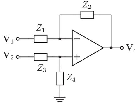
$$\mathbf{V}_o = \left( \frac{Z_4}{Z_3 + Z_4} \right) \left( \frac{Z_1 + Z_2}{Z_1} \right) \mathbf{V}_2 - \left( \frac{Z_2}{Z_1} \right) \mathbf{V}_1$$
